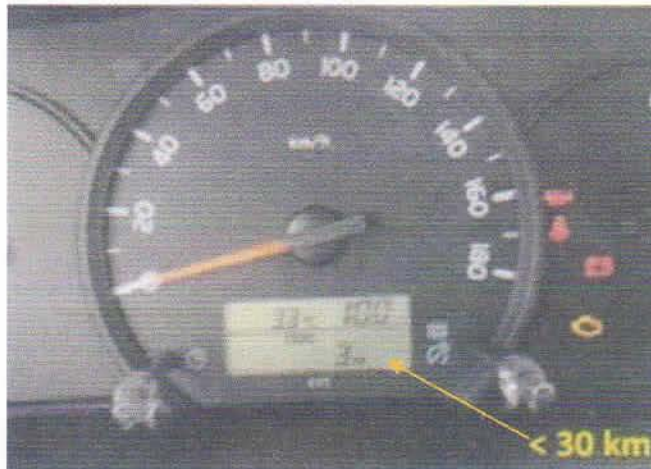
Odometer(SKD) (SKD-ဖြစ်လျှင် အများဆုံး 30 km မကျော်ရ)
