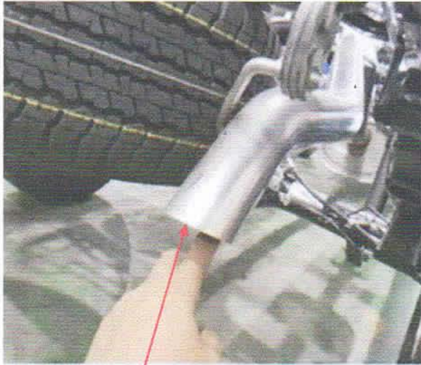
Exhaust Pipe အတွင်း၌ ကာဗွန်ဂျိုးများ မရှိရ
